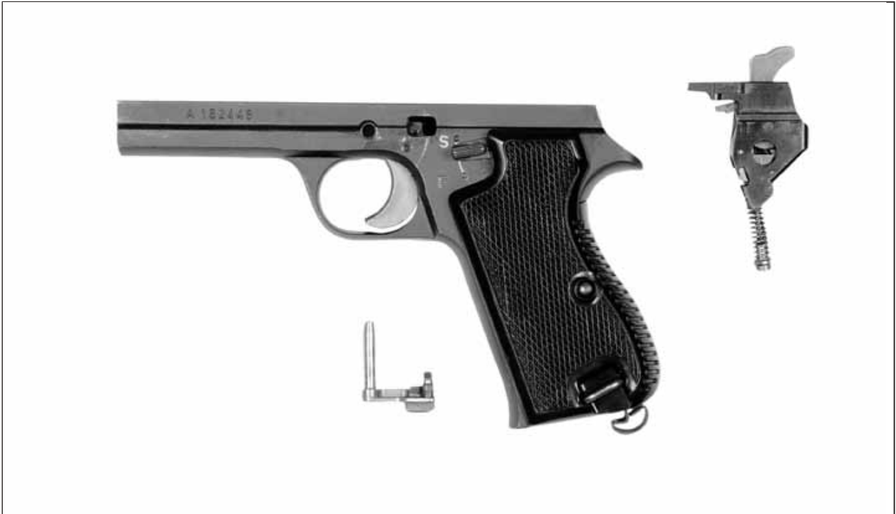
Abbildung 2: Beim Schuss feststehender Teil
