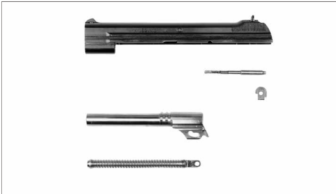
Abbildung 3: Beim Schuss beweglicher Teil
