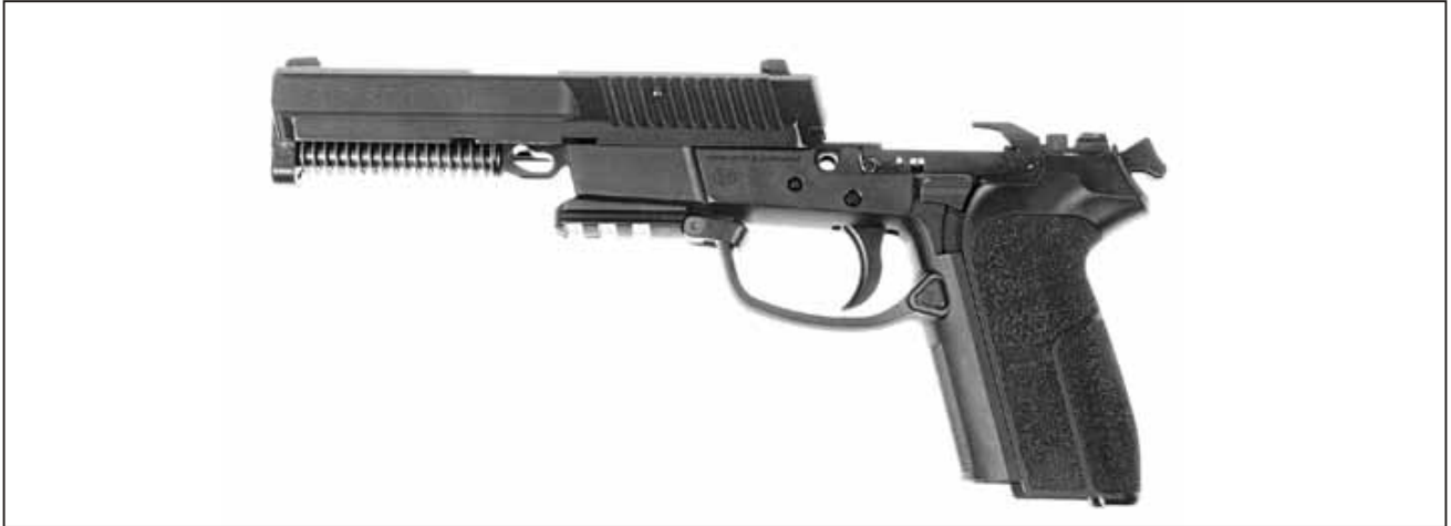
Abbildung 8: Verschlussstück auf das Griffstück von vorne aufschieben
